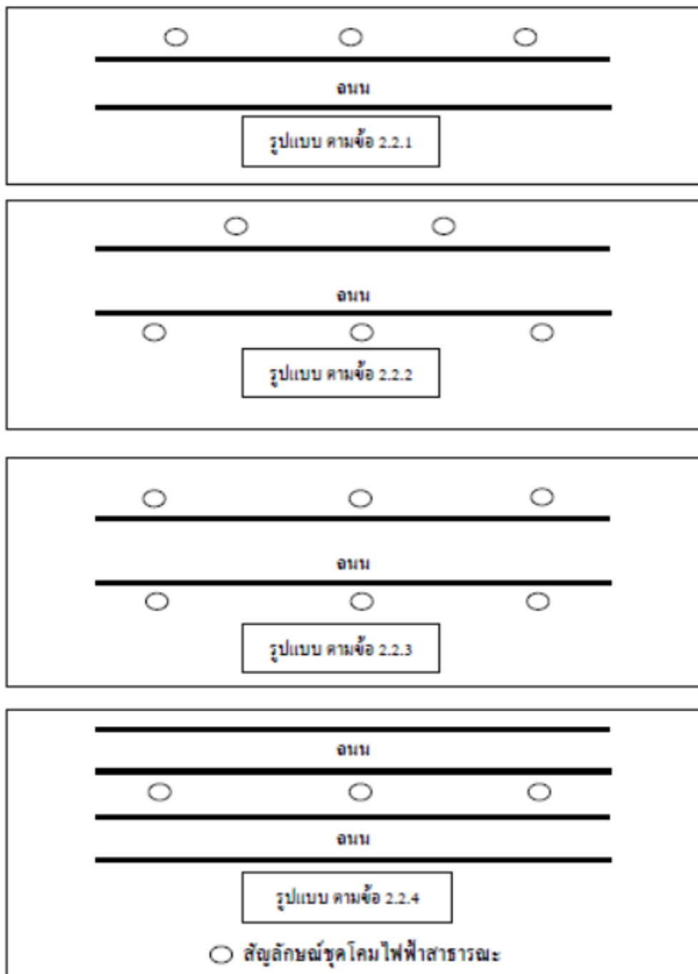
รูปที่ 2-1 การกำหนดรูปแบบ และจุดติดตั้งไฟฟ้าสาธารณะตามแนวนอนตามข้อ 2.2
