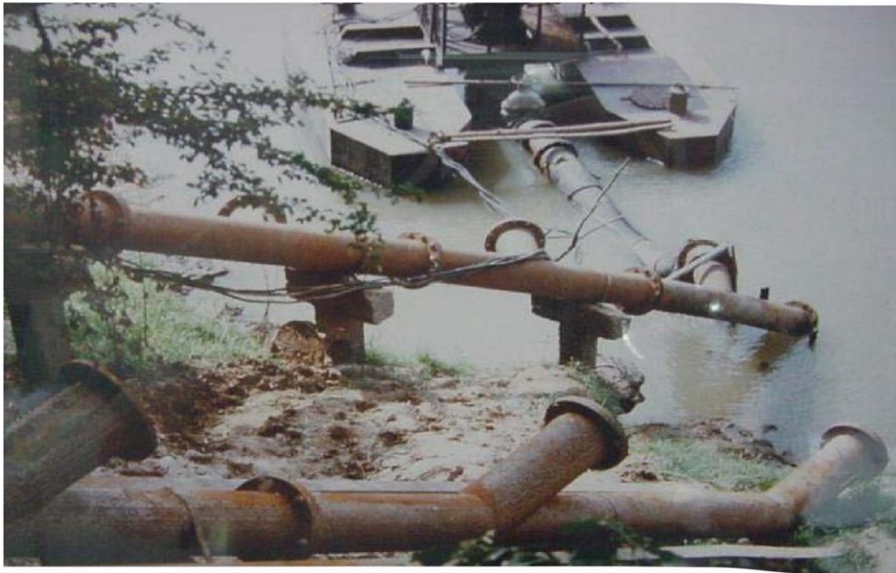
ภาพที่ 2.7 ลักษณะการติดตั้งเครื่องสูบน้ำบนแพ
